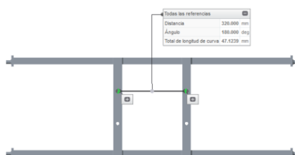
Fig. 2.30-Distancia horizontal entre taladros
