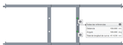
Fig. 2.31-Distancia vertical entre taladros
