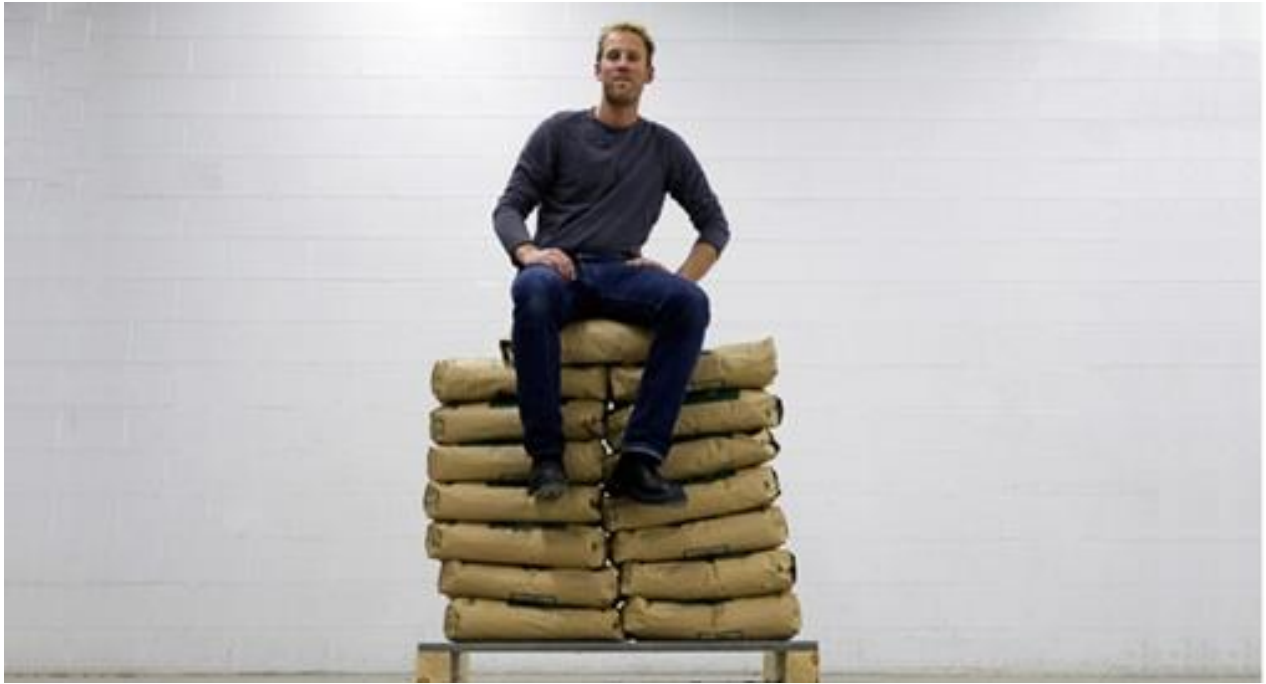
Figura 17. Prueba de resistencia a una plancha de HUAC de 3 cm de espesor sin refuerzo pasivo.
