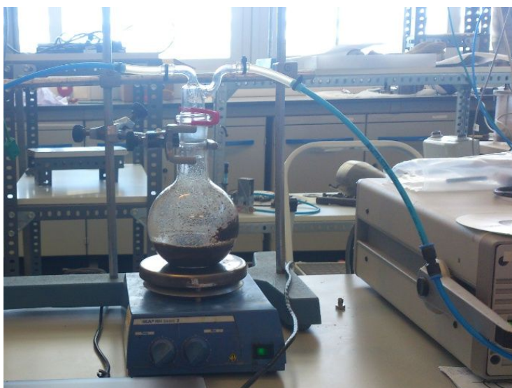
Figura 8. Montaje para el tratamiento ácido del purín midiendo los gases a la salida
