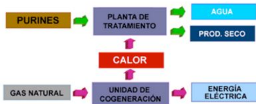
Figura 3. Esquema de funcionamiento de una planta de cogeneración [37]
