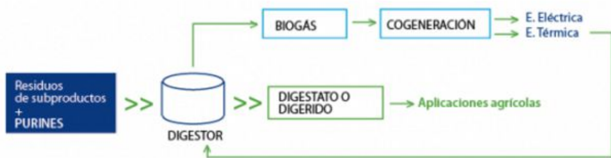
Figura 4. Esquema de funcionamiento de una planta de digestión anaerobia [37]
