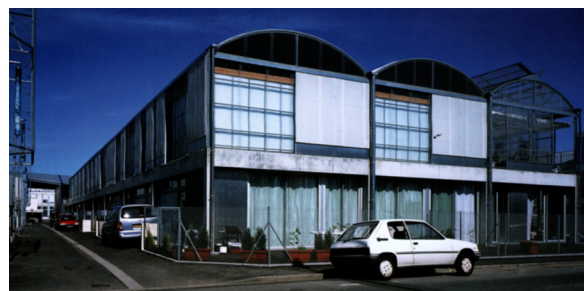
9.7 Fachada oeste. Espacios abovedados aislados térmicamente y espacio invernadero.
