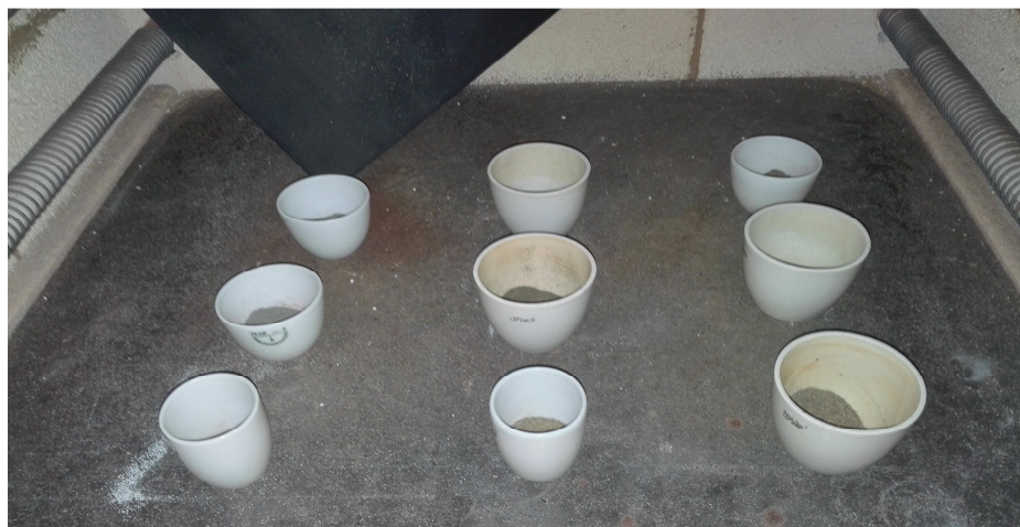
Figura 9. Disposición de los crisoles en el interior del horno de mufla.
