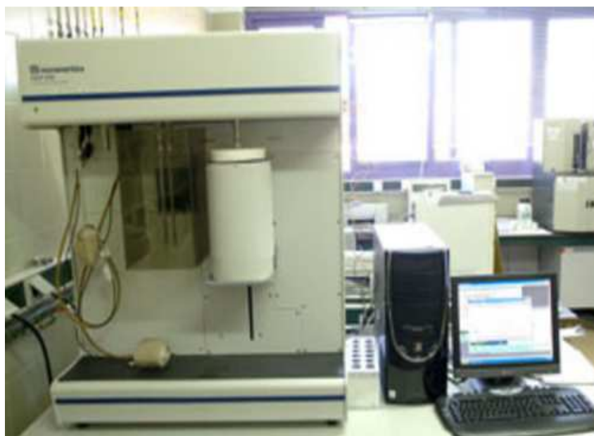
Figura 2. Equipo ASAP 2020 V.3 de Micromeritics que mide el área superficial BET.
