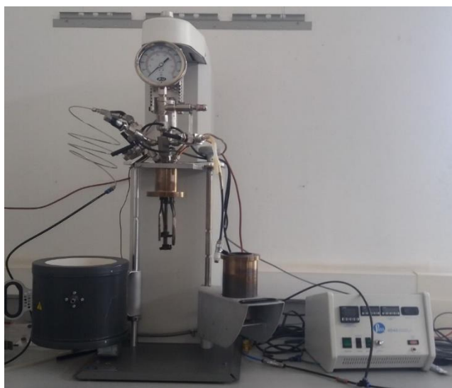
Figura 8: Reactor autoclave para la despolimerización de la lignina
