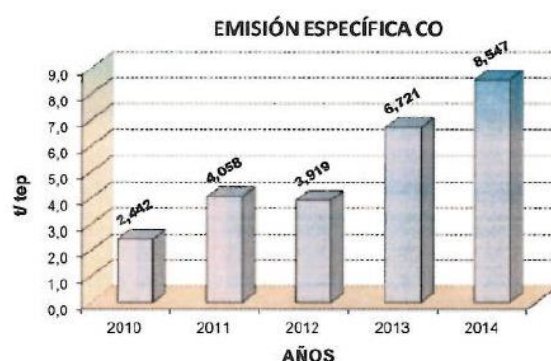
Figura 2. Emisiones específicas de CO. 2010-2014 [2]
