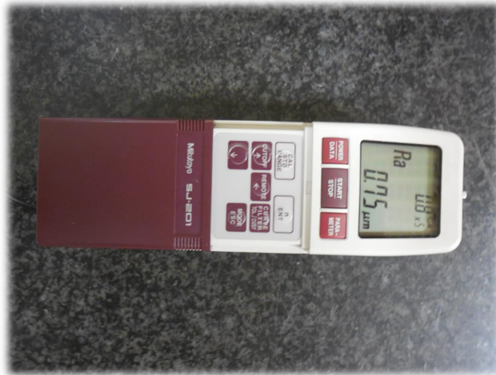
Figura 11. Rugosímetro Mitutoyo empleado para la medición de las muestras del estudio.
