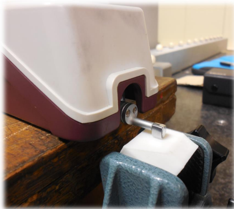
Figura 16. Medición de una de las muestras con el rugosímetro.
