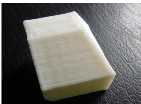
Figura 27. Pieza de baja calidad, se puede apreciar las capas a simple vista.
