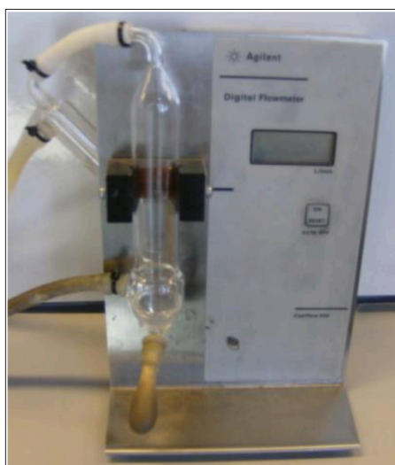
Figura A2: Medidor de caudal volumétrico
