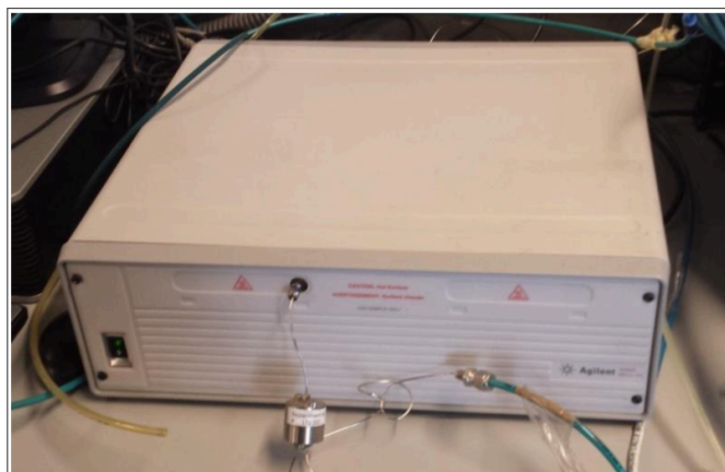
Figura A5: Microcromatógrafo de gases
