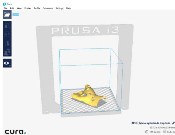
Ilustración 77 Posicionamiento de impresión 3D para férula mano - PRUSA
