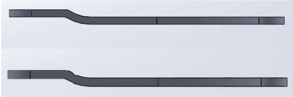
Figura 41: Espesor unión cabezal fijo-viga central, 25mm (arriba) 30mm (abajo).
