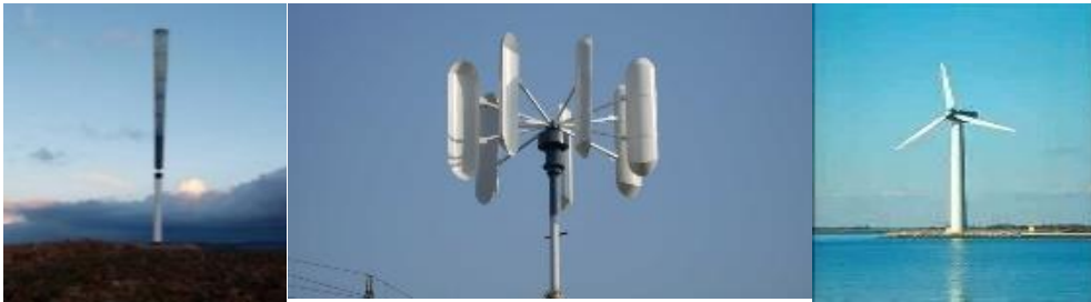
Fig. 6. Aerogeneradores de eje vertical, sin hélices y de eje horizontal [6]
