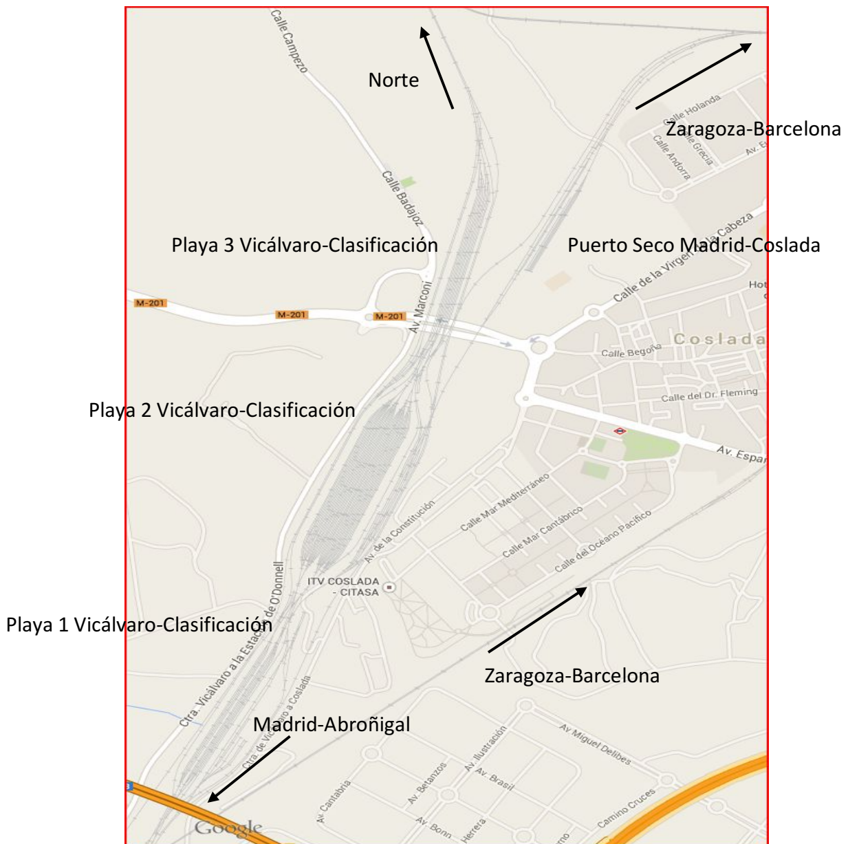
Figura 4. Esquema vías entronque Vicálvaro Clasificación-Coslada
