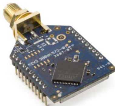
Figura 9. Módulo XBee XBee-PRO 868 [15]
