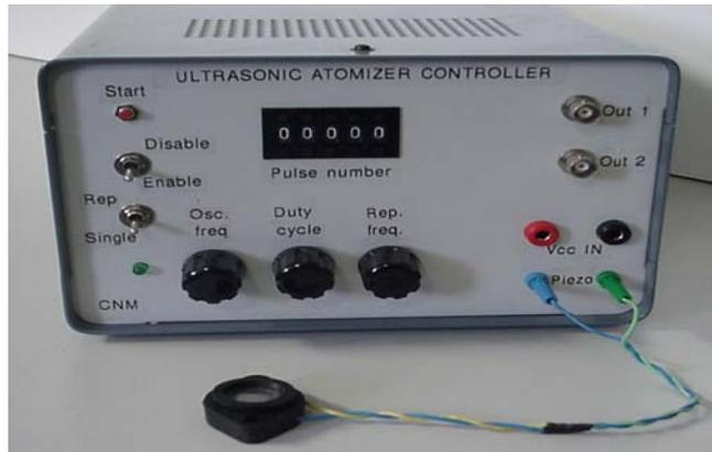
**Figura 7.5:** Fotografía del panel frontal del sistema de excitación de resonadores piezoeléctricos con el transductor PZT de 1,668 MHz conectado a la salida.
