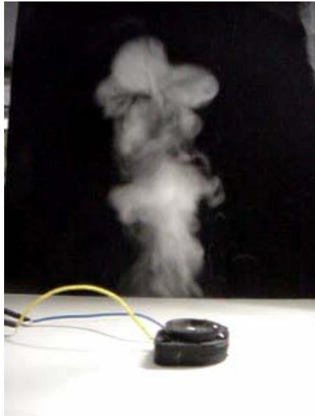
**Figura 7.10:** Nube de gotas generadas por el transductor piezocerámico excitado con el sistema pulsado UAC.
