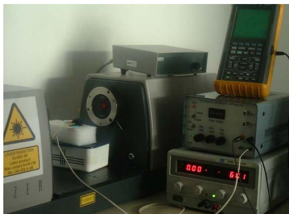
**Figura 7.8:** Fotografía del equipo de excitación de resonadores piezoeléctricos, integrado en un sistema de medida de tamaño de gota por difracción láser.
