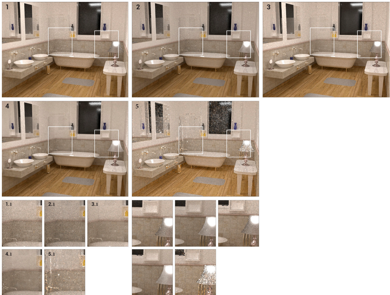
Figura 6. Escena Baño con iluminación artificial, renderizada con 500 muestras por, de izquierda a derecha y de arriba a abajo; path tracer, bidireccional PT, stochastic progressive photon mapping, primary sample space MLT, path space MLT. Las imágenes ampliadas en las que se puede obtener una visualización del ruido en la zona de la ventana, están ordenadas de la misma manera.
