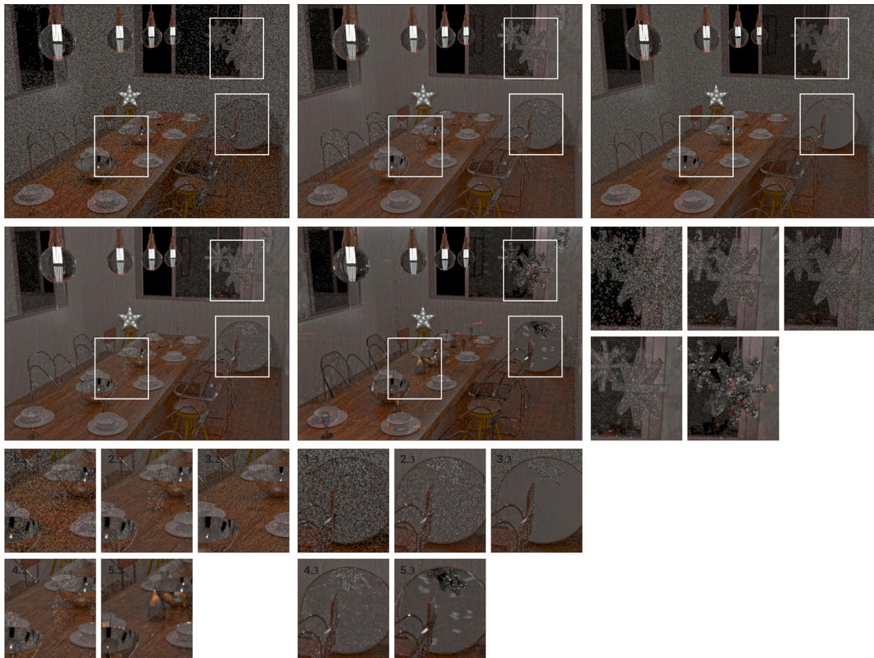
Figura 9. Escena Salón con iluminación artificial, renderizada con 1000 muestras por, de izquierda a derecha y de arriba a abajo; path tracer, bidireccional PT, stochastic progressive photon mapping, primary sample space MLT, path space MLT. Las imágenes ampliadas en las que se puede obtener una visualización del ruido en la zona de la ventana, están ordenadas de la misma manera.
