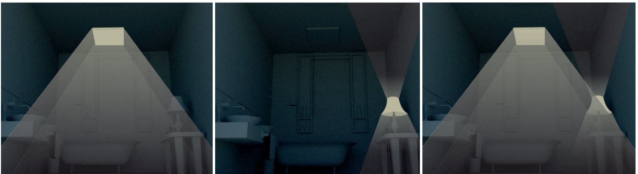
Figura 5.9. Esquema de simulación de la iluminación por separado sobre la escena en total oscuridad de los focos seleccionados. De izquierda a derecha; foco A, foco E, y de los focos A y E juntos.
