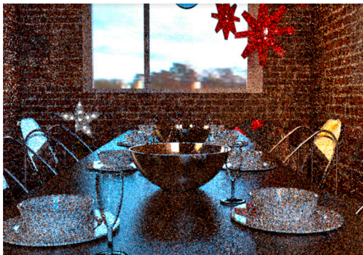
Figura 2.5. Exceso de ruido en el render de una de las escenas tridimensionales diseñadas, Escena Salón , provocado por la pequeña cantidad de muestras empleadas a la hora de trazar caminos de luz. Se han empleado 8 muestras por píxel. Aumentando el número de muestras se obtiene inmediatamente una mejor calidad del render debido a su reducción de ruido, pero el tiempo de computación también aumenta significativamente como consecuencia.
