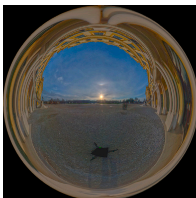
Figura 21. Mapa de ambiente proporciona iluminación luz natural al conjunto de la escena. Su grado de luminosidad puede controlarse con el nivel de exposición.
