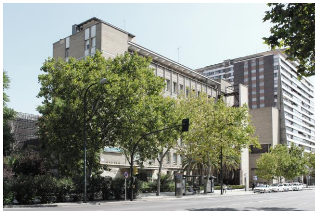
Fig. 48 Zonas exteriores en torno a la fachada principal con elementos que obstaculizan el espacio de maniobra de los bomberos.
