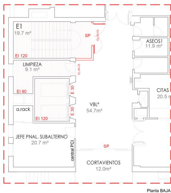
Fig. 41 Detalle de la nueva sectorización de la escalera protegida en planta baja.
