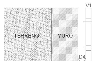
Fig 45. Solución D4+V1 para muros en contacto con el terreno.
