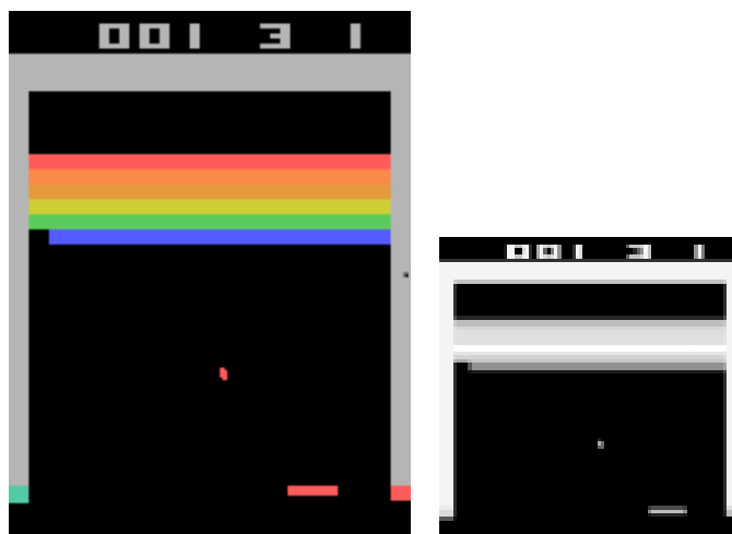
Figura 7: Pre-procesamiento de frames. En la izquierda la imagen original. En la derecha el resultado del pre-procesamiento de la imagen original.
