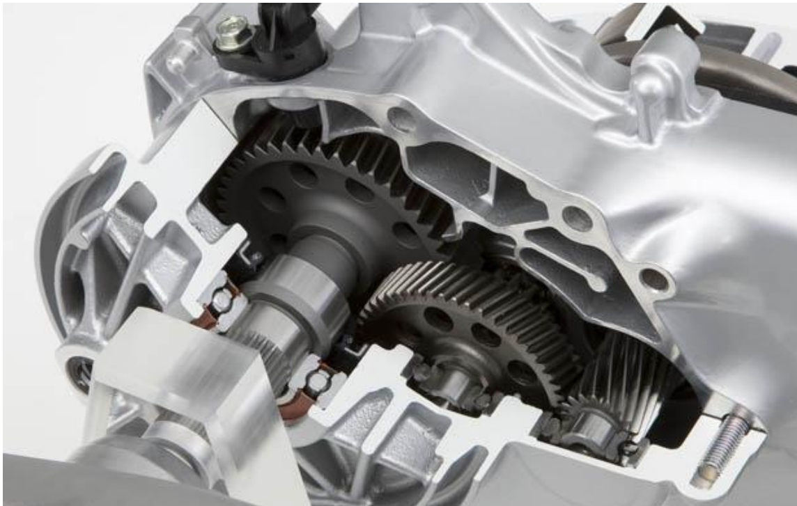
Imagen 1. Sistema reductor de una motocicleta.
