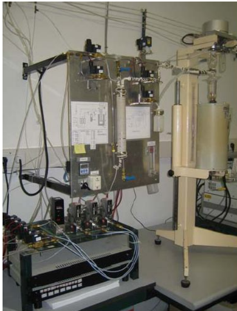
Figura 2.2. Fotografía del sistema experimental de la TGA y esquema de la balanza termogravimétrica.
