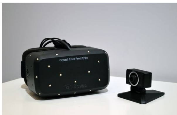
Figura 4.1: En esta imagen del prototipo del Oculus Rift DK2 se pueden ver los leds infrarrojos que emplea la cámara infrarroja para detectar la posición relativa del Oculus respecto de la pantalla donde se sitúa la cámara
