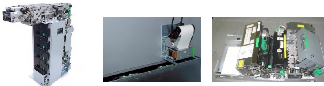
Figura D.1.3.a (izquierda). Sistema de recogida de billetes G60 del ATM Fujitsu serie 100. / Figura D.1.3.b (centro). Impresora de recibos del cajero Siglo. / Figura D.1.3.c (derecha). Módulo de libretas del ATM Fujitsu serie 100.
