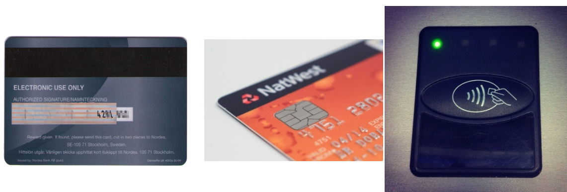
Figura D.1.2.a (izquierda). Banda magnética de una tarjeta de crédito. / Figura D.1.2.b (centro). Smart Card, donde se puede apreciar los contactos del microchip. / Figura D.1.2.c (derecha). Lector de tarjetas con tecnología contactless.
