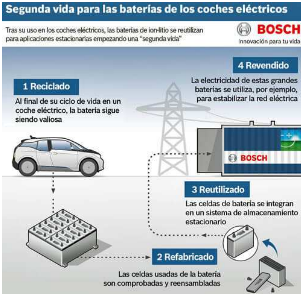
Figura 17. Esquema reutilización baterías de litio [54]
