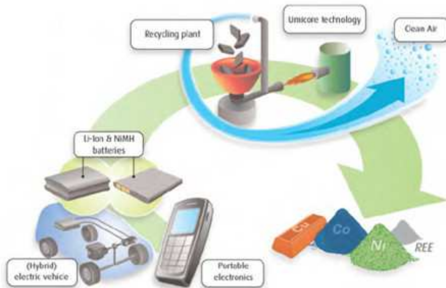
Figura 16. Esquema de reciclaje baterías NiMH [52]
