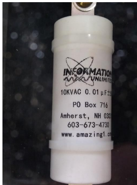
Figura Anexo 6.6. Condensador primario.
