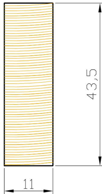
Figura Anexo.4.2. Alzado de la bobina secundaria con medidas expresadas en cm.
