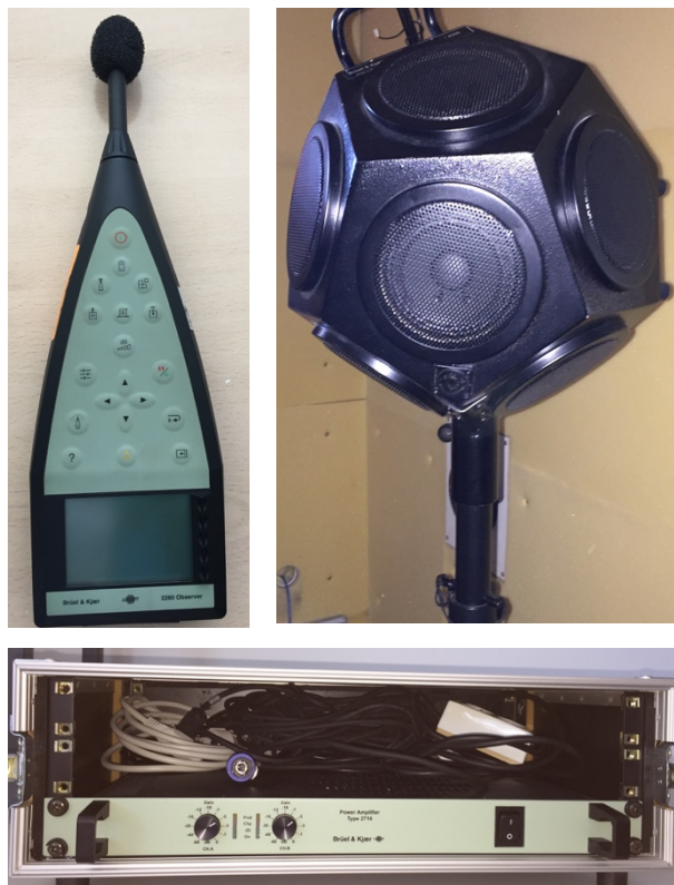
Figura 7.- Izquierda, Sonómetro Brüel & Kjaer BK 2260. Derecha, fuente de sonido omnidireccional Brüel & Kjaer OmniPower 4296. Abajo, amplificador, Brüel & Kjaer Power Amplifier Type 2716
