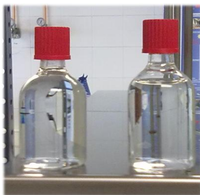
Figura 1. Reactores utilizados en los experimentos Fenton de determinación de producción de ROS
