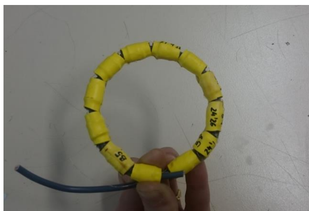
Figura 5.3. Sonda con los carretes colocados sobre el conductor.
