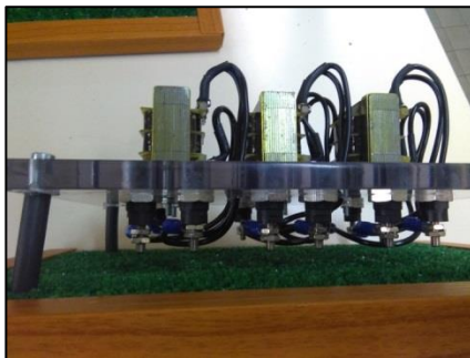
Fig. 6.7. Vista lateral de los transformadores.
