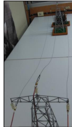
Fig. 5.2. Conexión del cable de acero entre las torres 1 y 2.
