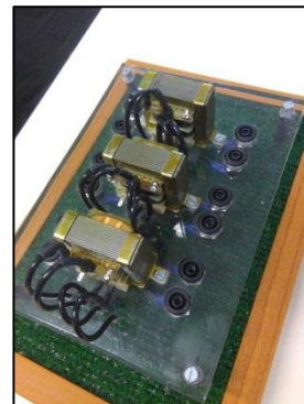
Fig. 6.8. Banco de transformadores.
