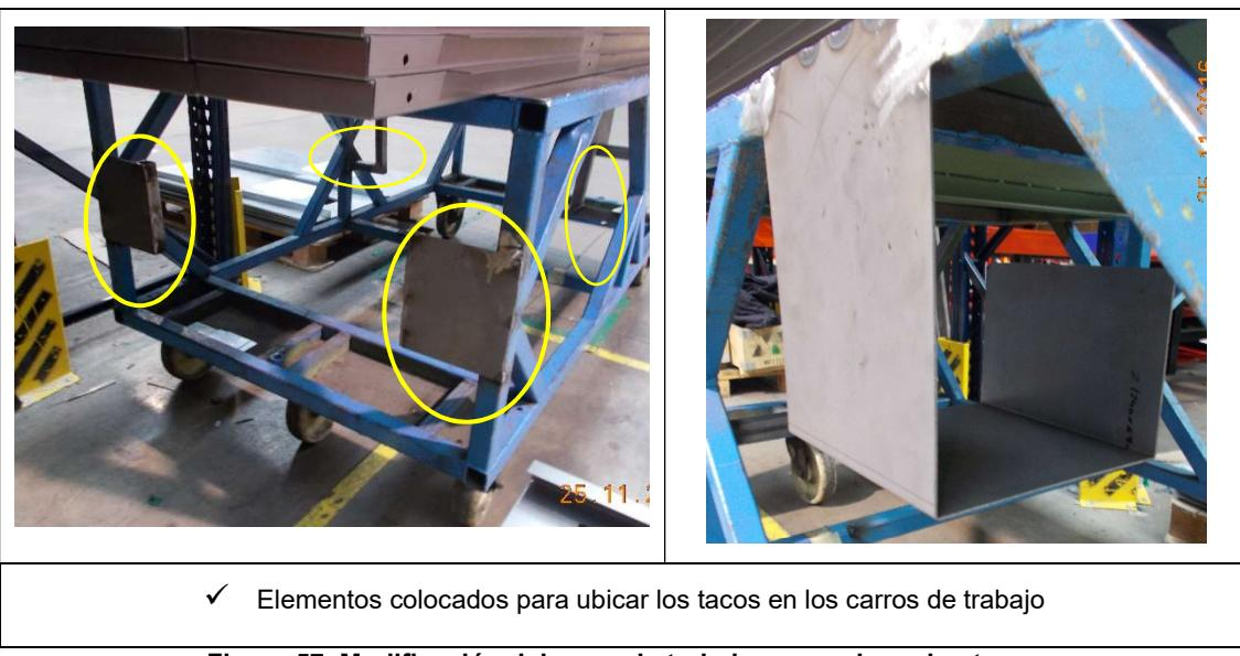
Figura 57. Modificación del carro de trabajo para colocar los tacos
