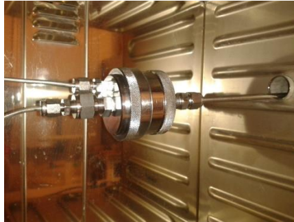
ILUSTRACIÓN 16: PLANTA DE PERVAPORACIÓN. (MÓDULO DE MEMBRANA)
