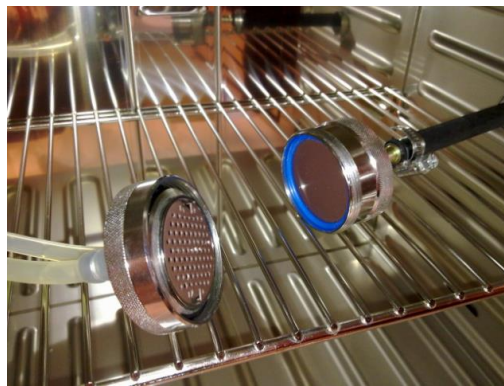
ILUSTRACIÓN 17: PLANTA DE PERVAPORACIÓN. (INTERIOR DEL MÓDULO DE MEMBRANA)
