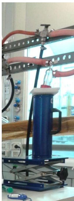
ILUSTRACIÓN 18: PLANTA DE PERVAPORACIÓN. (CONDENSADOR EN “DEWAR” DE NITRÓGENO)
