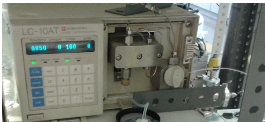
ILUSTRACIÓN 15: PLANTA DE PERVAPORACIÓN. (BOMBA DE LÍQUIDOS)
