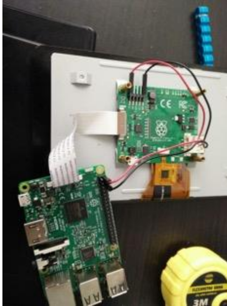
Figura 36 – Detalle de la Raspberry Pi 3 y la trasera de la pantalla táctil
