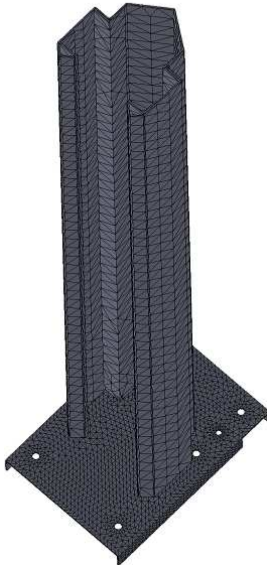
Fig.A.8.1. Mallado del conjunto.
