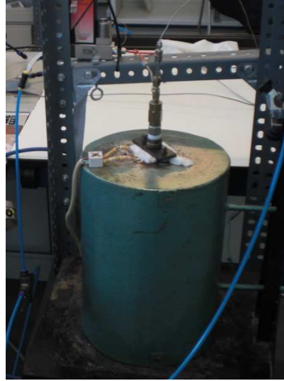
Figura C- 6: Horno con el reactor en su interior
