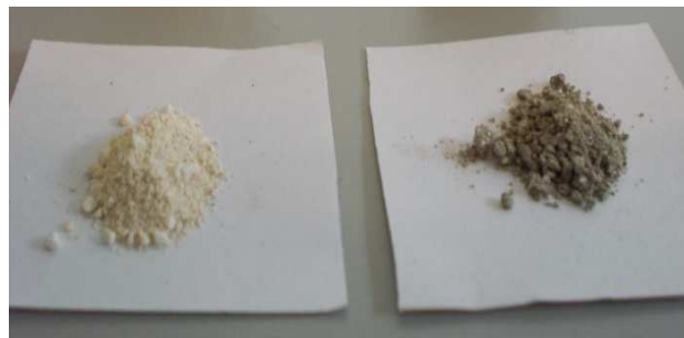
Figura B- 5: Cenizas de carne (a la izquierda, experimento 11) y cenizas de hueso (experimento 9) de pirólisis con el lecho agitado mecánicamente
