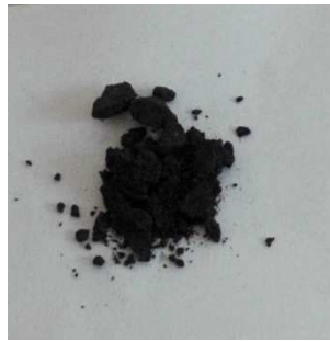
Figura B- 4: Char de pirólisis con el lecho agitado mecánicamente
