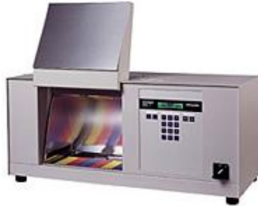
Figura 6.4. Cámara de simulación solar
