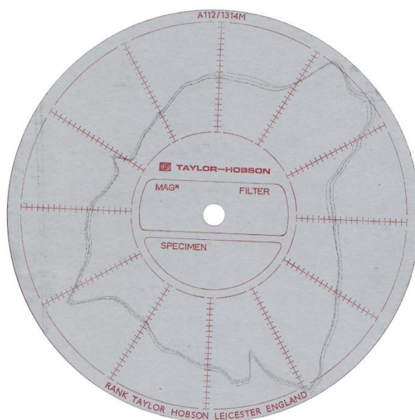
Figura 50. Error de centrado y rugosidad de la esfera del SMR (escala 2\ \mu\text{m} )
