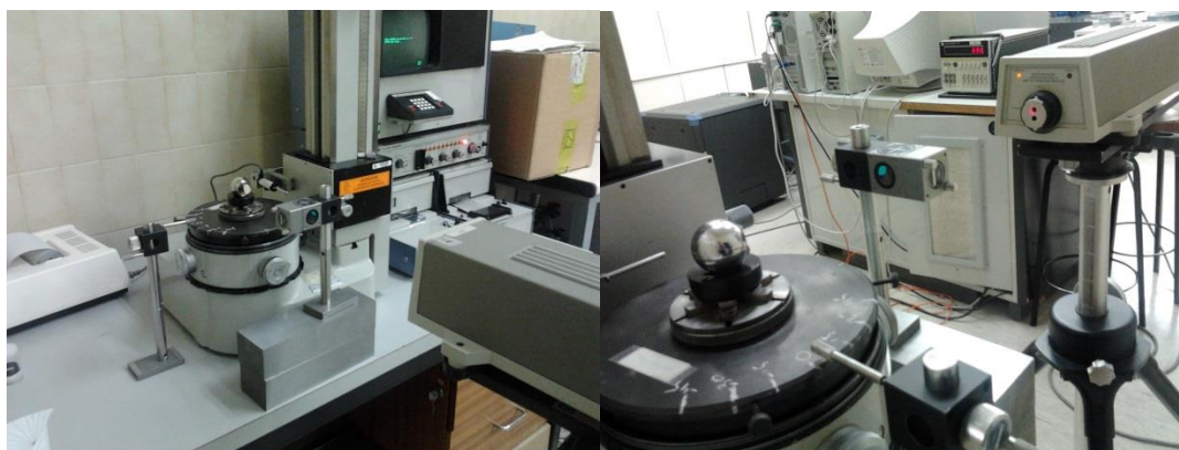
Figura 51. Ensayo de medición del SMR en mesa de redondez
