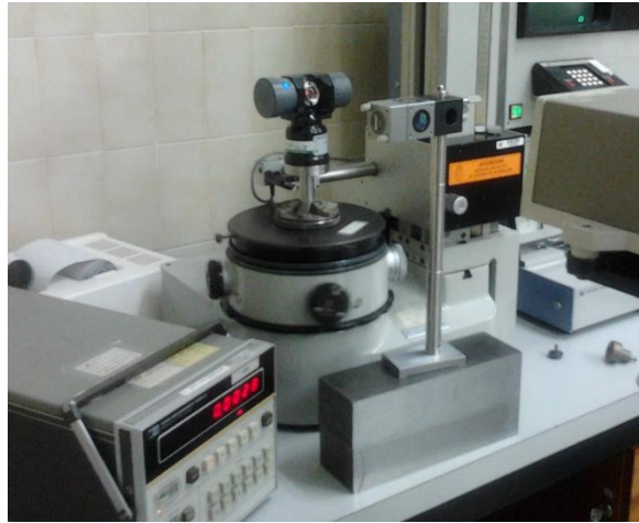
Figura 26. Medición del error en el eje vertical del Active Target
