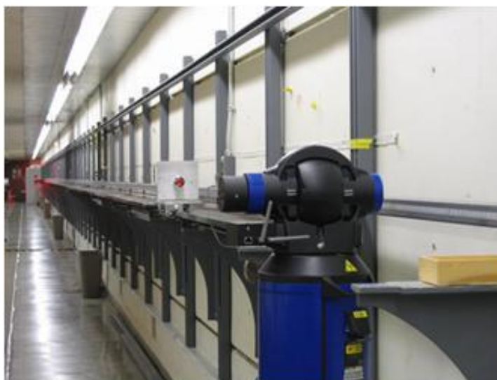
Figura 5. Ensayo de alcance en una guía lineal calibrada
