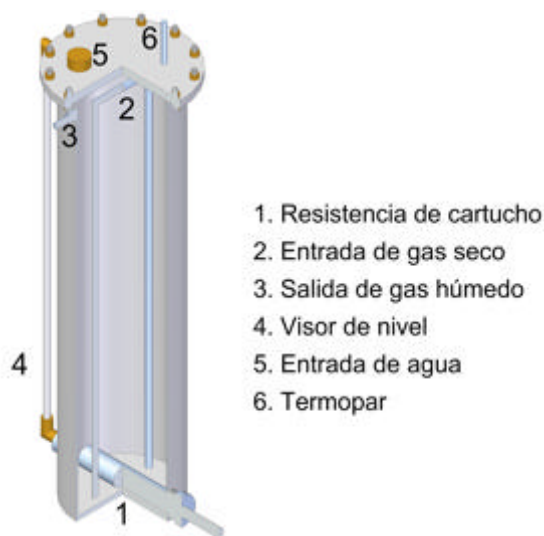
Figura 3.7 Imagen 3-D del diseño del humidificador
