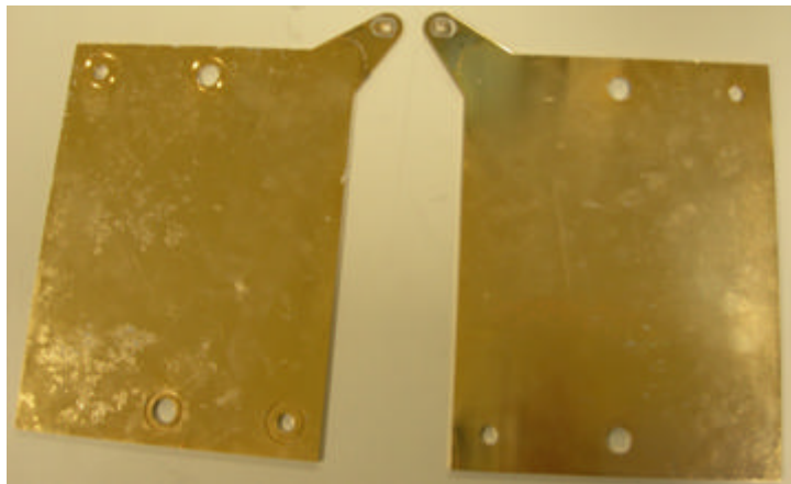
Figura 6.7 Fotos de las dos caras de los colectores de corriente de esta pila
