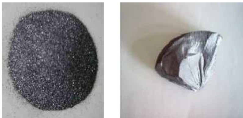
Figura 23. Silicio amorfo (izda.) y Silicio cristalino (dcha.).
