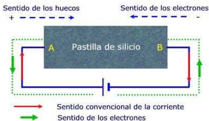
Figura 14. Sentido de movimiento de un electrón y un hueco en el silicio.
