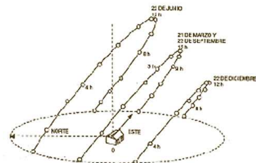
Figura 7. Trayectorias estacionales para un punto situado a 40^\circ latitud Norte
