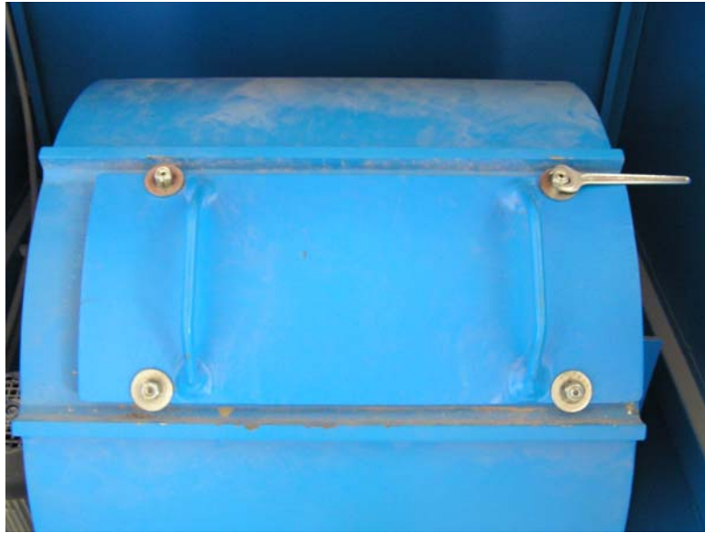
Imagen 35. Tambor cerrado máquina de desgaste
