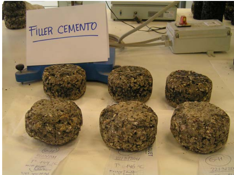
Imagen 53. Fila superior, tras ensayo cántabro seco.
