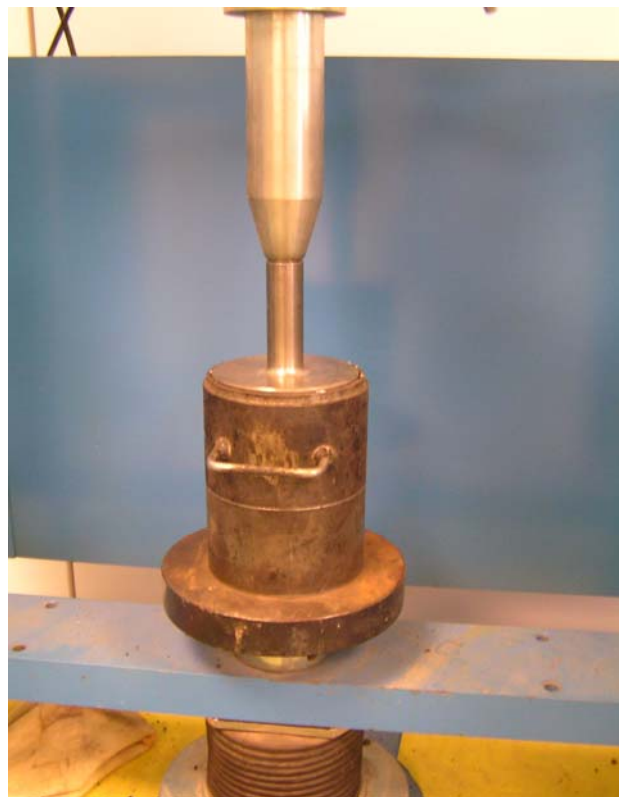
Imagen 29. Precisión en el ajuste para desmoldar, empleando el disco extractor
