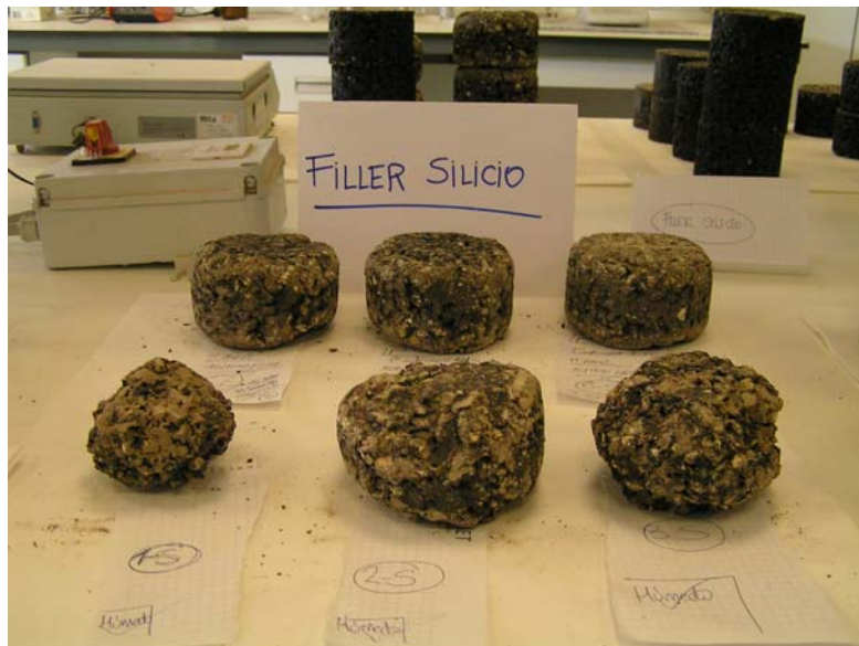
Imagen 51. Fila superior, tras ensayo cántabro seco.
