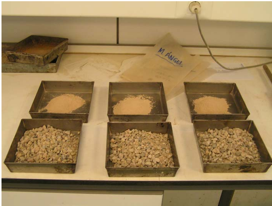
Imagen 16. Bandejas con contenido de áridos, para 3 probetas. El filler se puede apreciar que va a parte (bandejas superiores).
