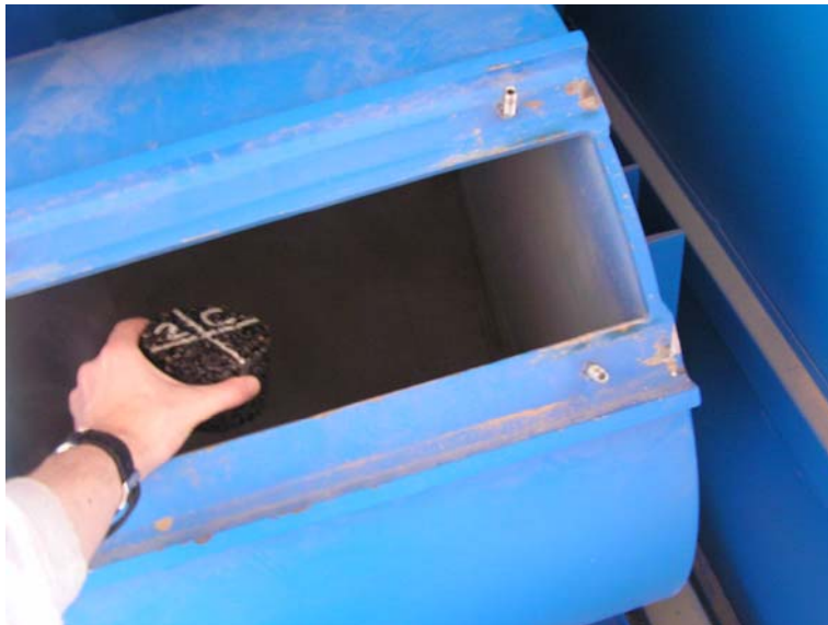
Imagen 34. Probeta a ensayar dentro del tambor
