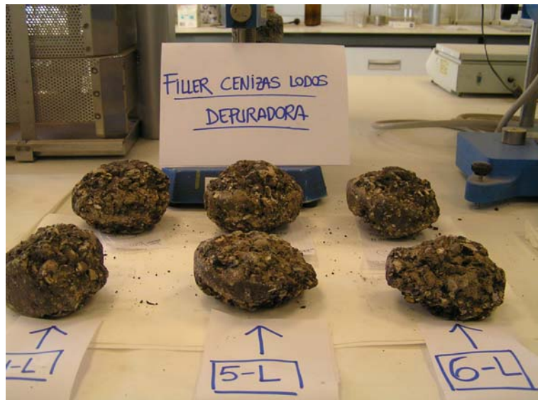
Imagen 54. Fila superior, tras ensayo cántabro seco.
