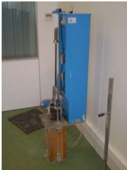
Imagen 26. Máquina de compactación
