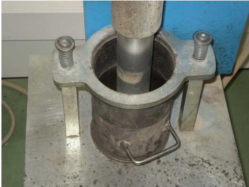
Imagen 25. Ajuste del conjunto de compactación en los resortes de la máquina de compactación
