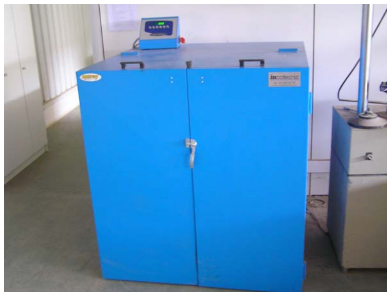
Imagen 36. Máquina de desgaste con las puertas de seguridad cerradas
