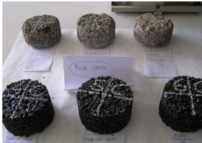
Imagen 38. Probetas antes ( fila inferior) y después ( fila superior) del ensayo Cántabro
