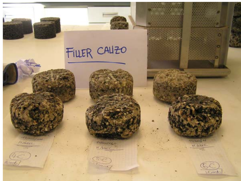
Imagen 52. Fila superior, tras ensayo cántabro seco.
