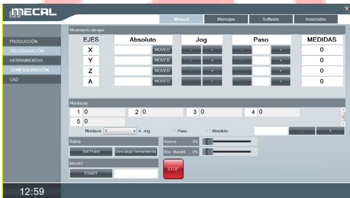
Figura 73: Imagen en la que se muestra las posibilidades del programa CAD-Cam de poder mover los ejes, posición de los mismos, de las mordazas, etc....
