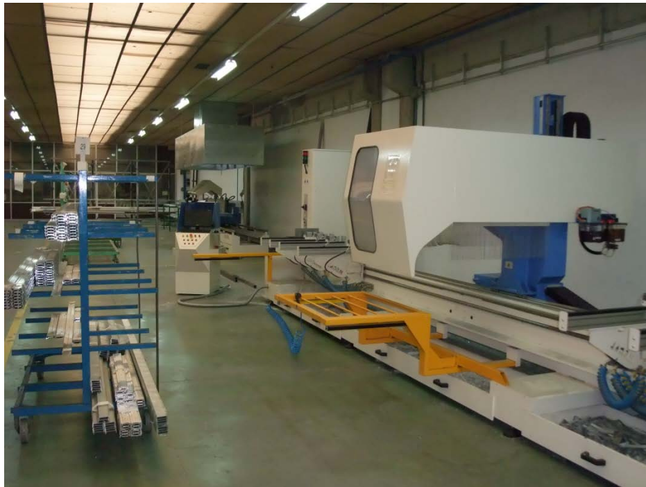
Figura 48: Imagen en la que se aprecia las zonas de trabajo, elementos de seguridad del centro de mecanizado y la continuidad con la máquina de corte.
