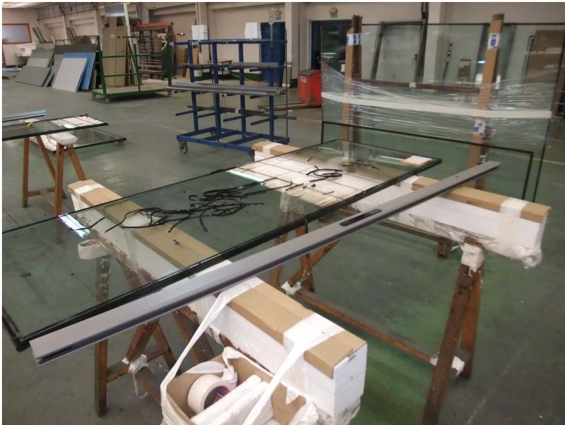
Figura 9: Ejemplo de acristalamiento de una hoja de ventana corredera.
