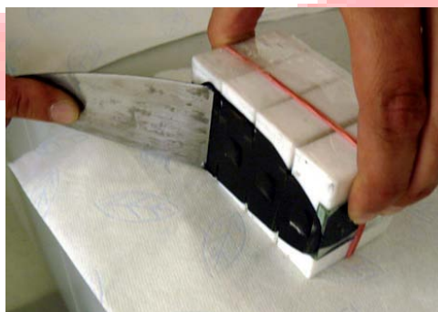
Figura 42: Se realiza un sellado con silicona para poder obtener las muestras que posteriormente serán ensayadas.
