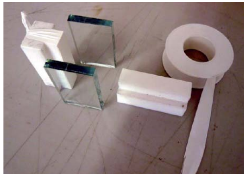
Figura 40: Se pueden realizar pruebas vidrio-silicona-vidrio, aluminio-silicona-vidrio o incluso aluminio-silicona-aluminio. En este caso se realizara vidrio-silicona-vidrio.
