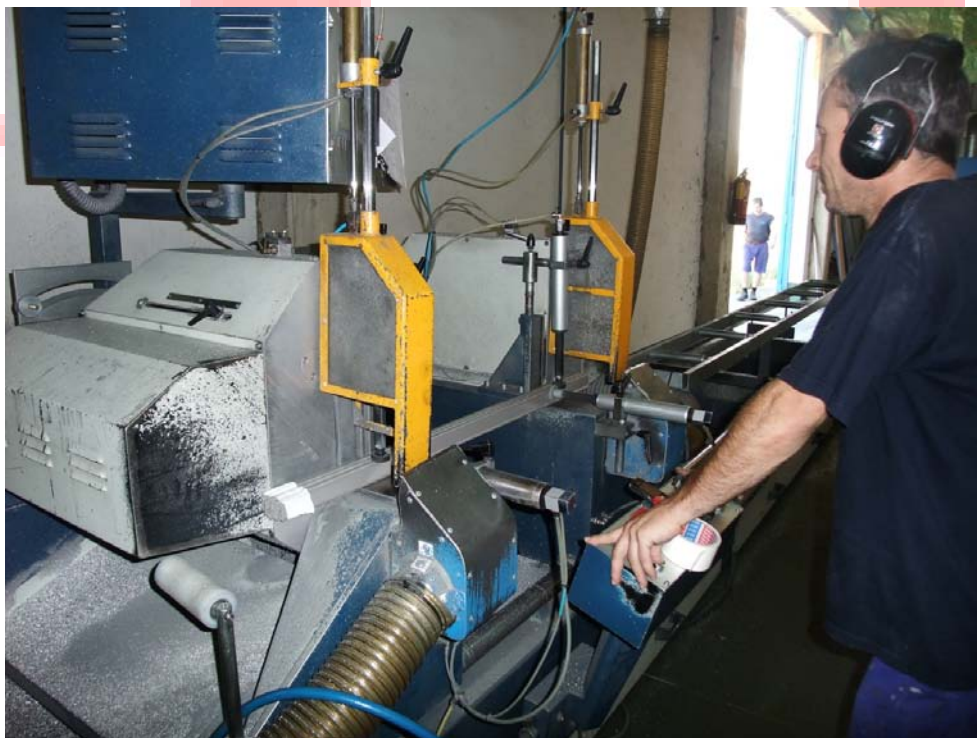
Figura 4: Proceso de corte de los perfiles de aluminio.
