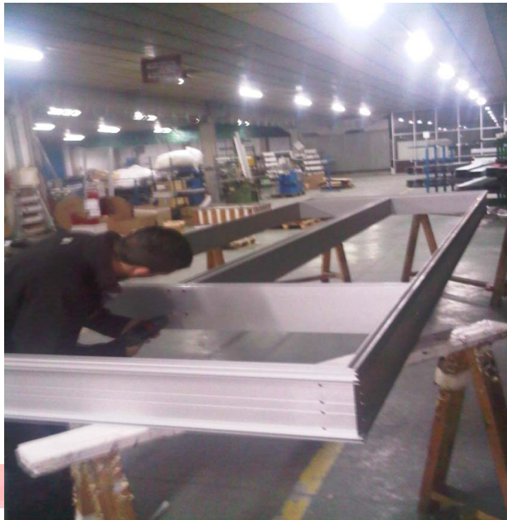
Figura 49: Montaje y sellado de un modulo de muro cortina.
