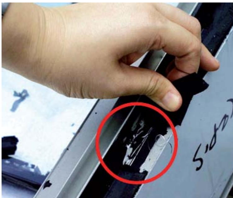
Figura 38: Cordón con una mala adherencia. Caso claro de una mala calidad de la silicona. No es apta para realizar los sellados.
