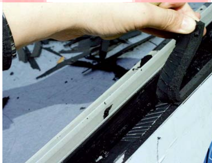
Figura 37: Cordón con una buena adherencia al realizar el proceso de control de calidad.
