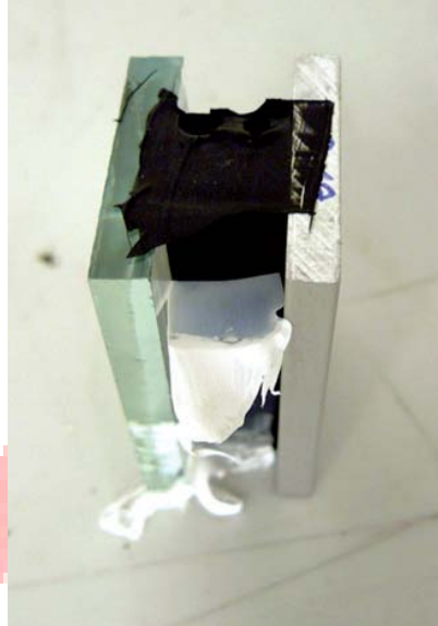
Figura 43: Probeta para realizar un ensayo de tracción.
