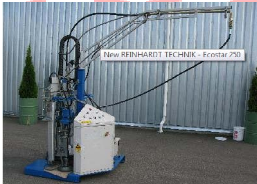
Figura 13: Máquina de sellado con bicomponente Ecostar-250.
