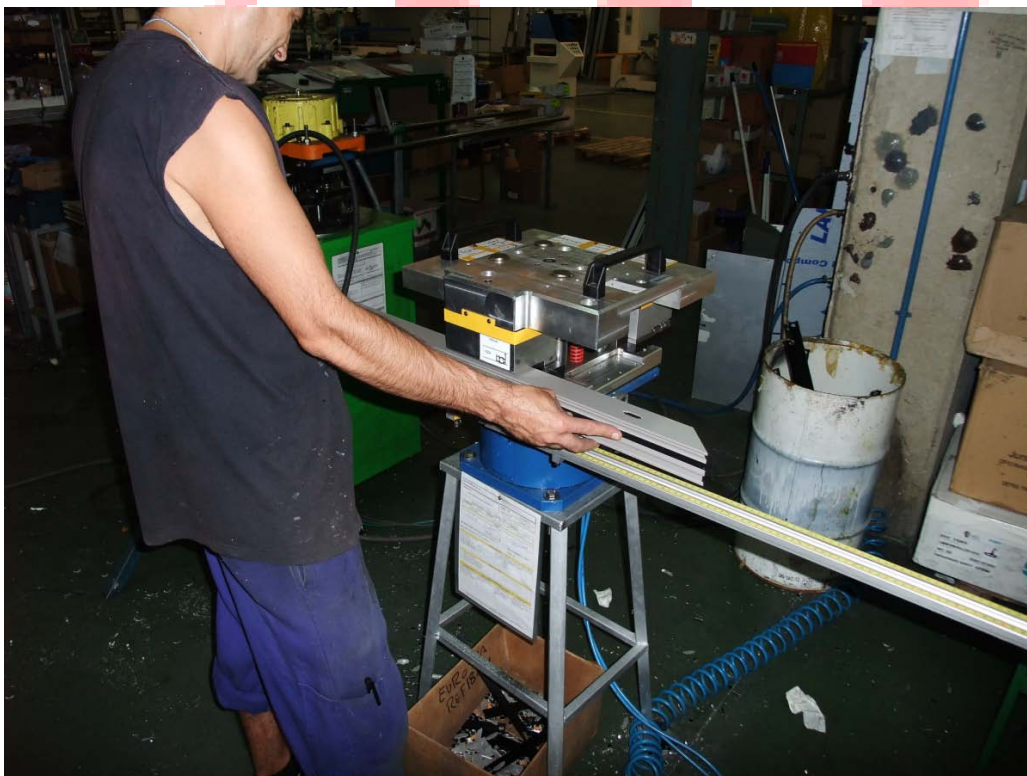
Figura 5: Mecanizado de desagües por medio de una matriz.
