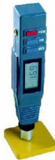
Figura 36: Durómetro utilizado en los ensayos de dureza shore.
