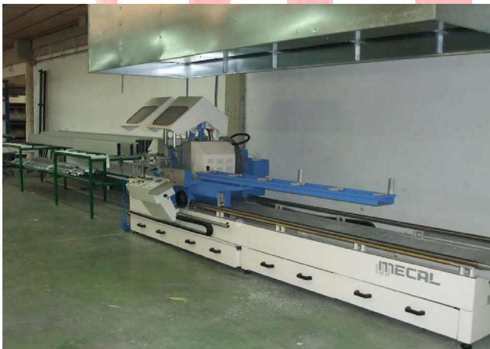
Figura 46: Máquina de corte con campana extractora y zona de abastecimiento de la misma
