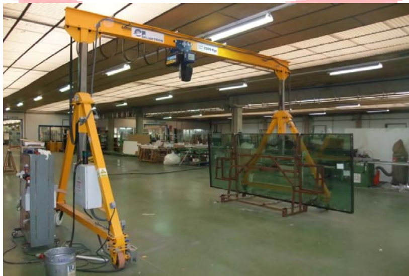
Figura 51: Pórtico ligero y vidrio para la fabricación de muro cortina sistema modular.
