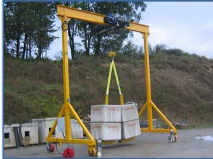
Figura 57: Pórtico ligero ofertado por la empresa Selmetron con movimientos motorizados.
