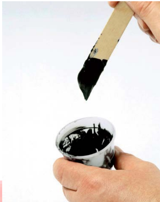
Figura 32: Momento en el que la silicona se encuentra en estado parcialmente sólida.
