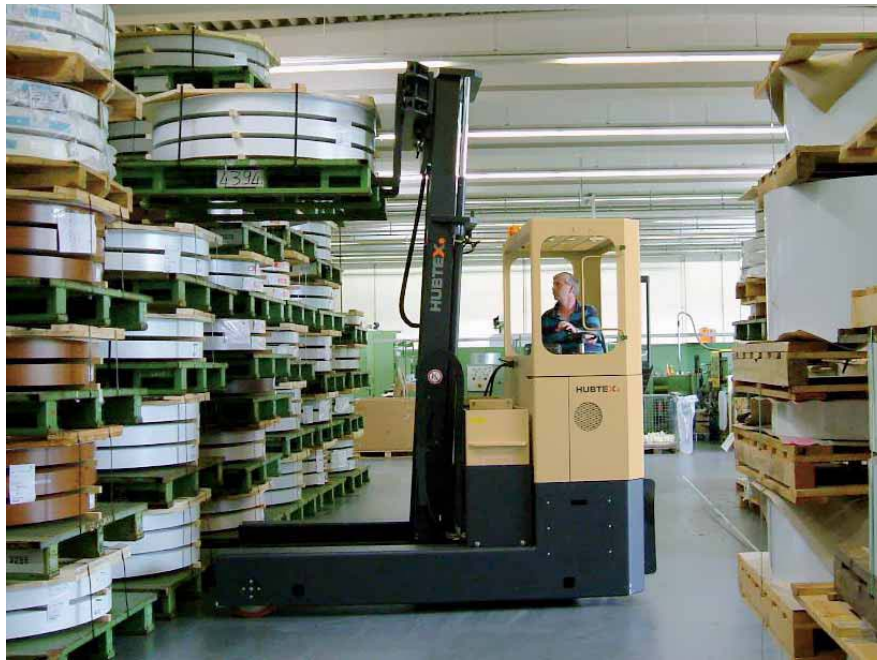
Figura 61: Ejemplo de posibilidad de movimiento que pueden ser realizados con la carretilla 4 caminos.
