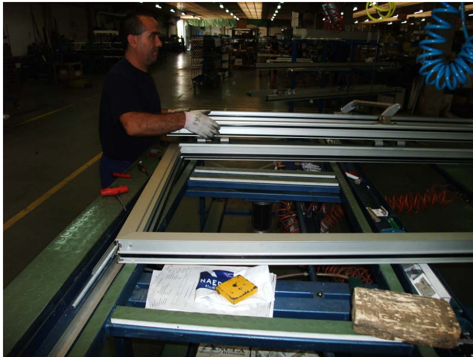
Figura 7: Imagen de el proceso de ensamble y montaje de una puerta abisagrada.
