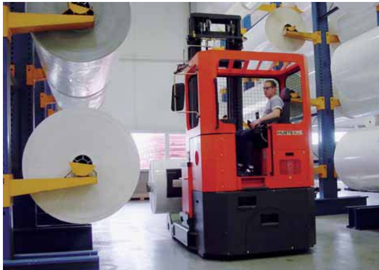
Figura 62: Ejemplo de movimiento rectilíneo de la carretilla 4 caminos.
