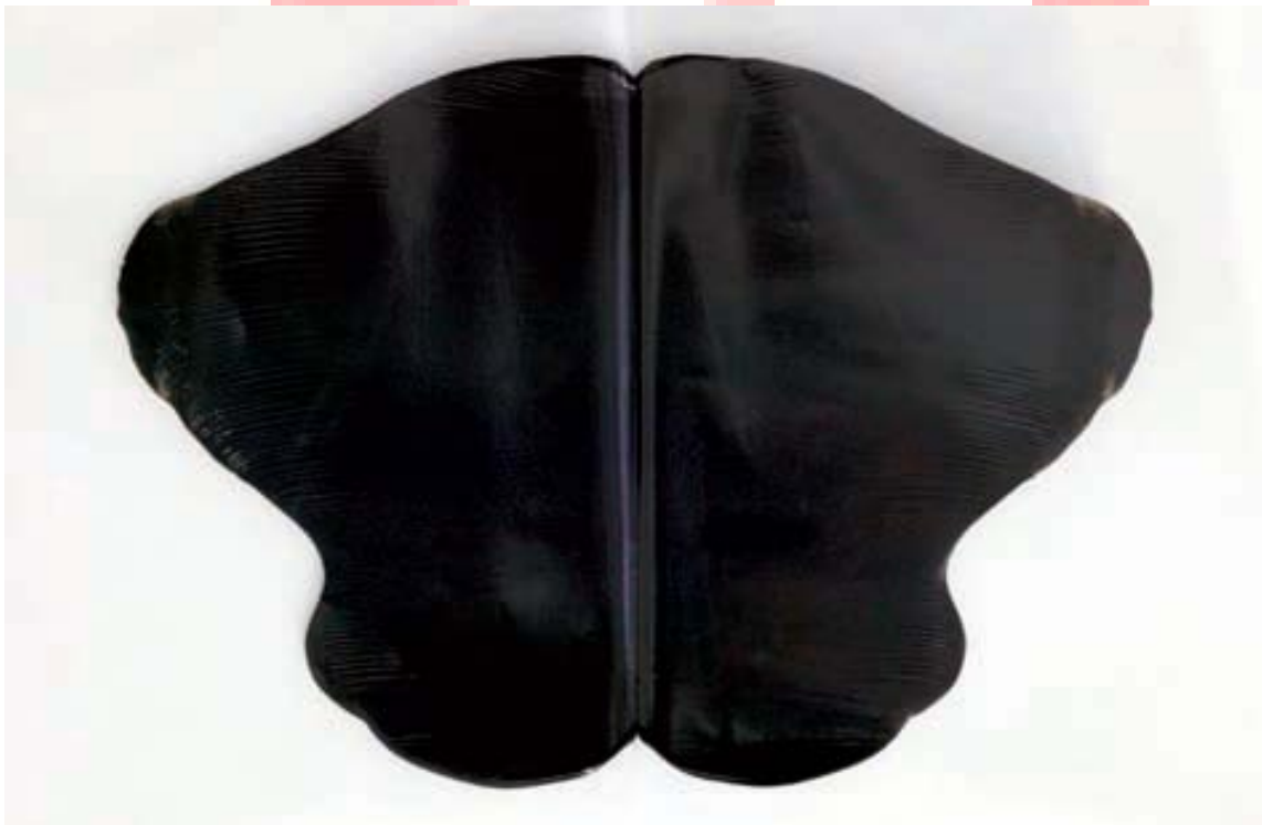
Figura 29: Prueba de la mariposa correcta que muestra una total homogeneidad.
