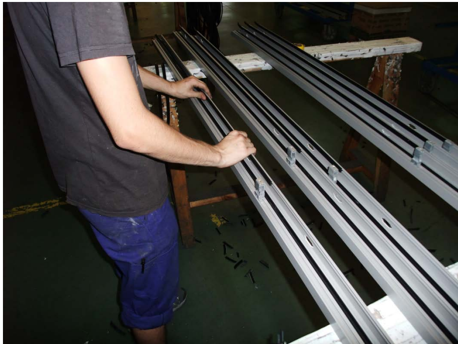
Figura 6: Inserción de gomas manualmente en perfiles de aluminio.
