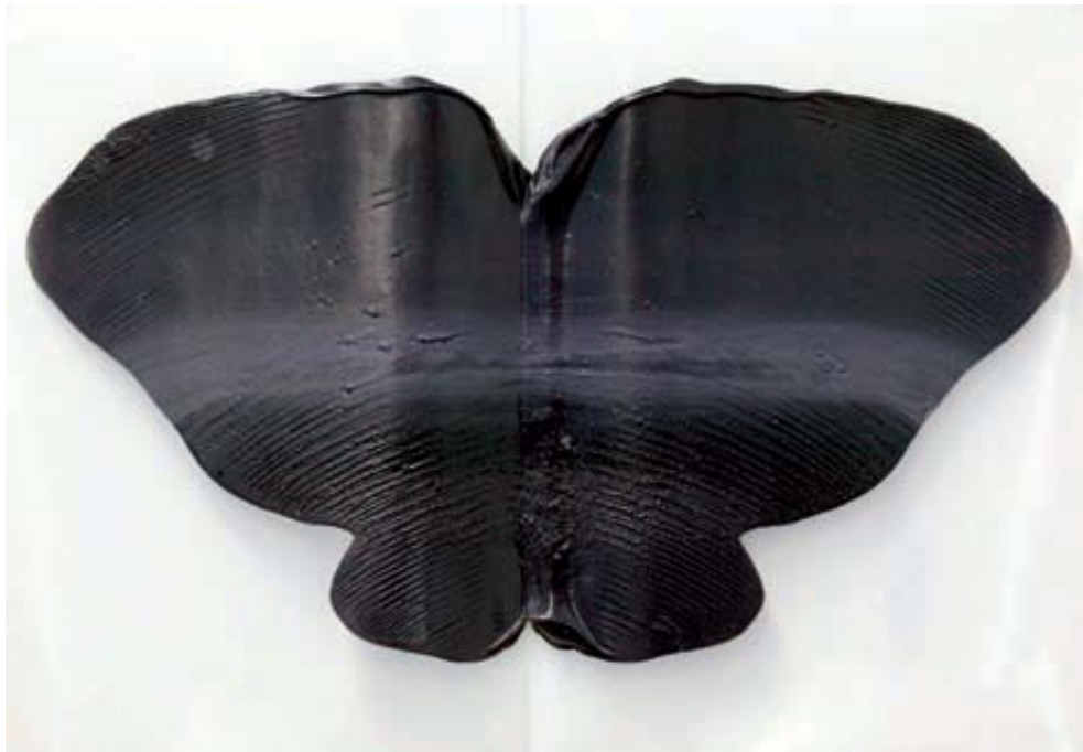
Figura 30: Prueba da la mariposa realizada con un resultado negativo.
