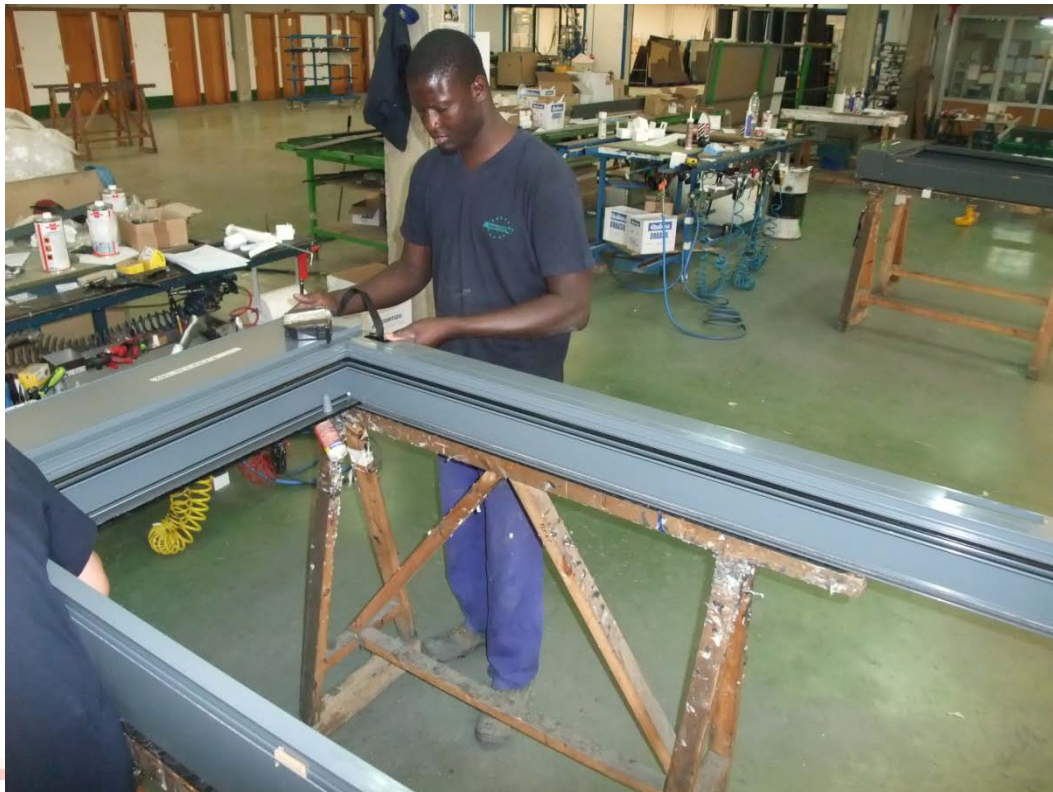
Figura 8: Introducción de un cajón de persiana en un marco de balconera.
