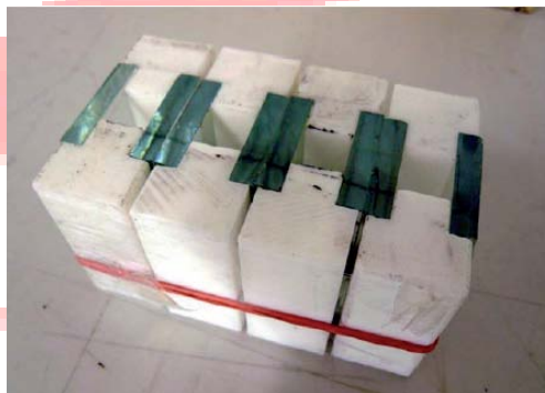
Figura 41: Se realiza una separación entre los elementos que han de ser pegados para poder introducir la silicona.
