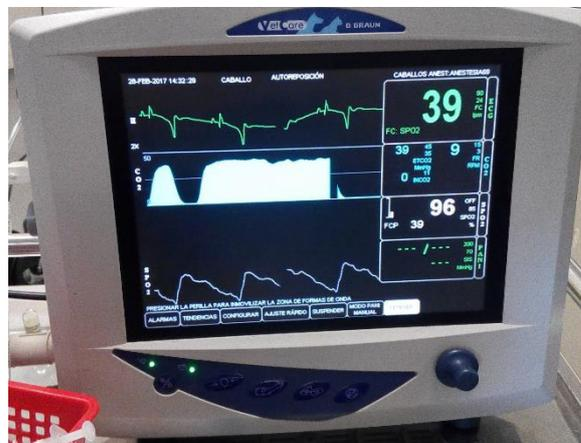
Imagen 3. Monitor anestésico que muestra electrocardiograma, frecuencia cardiaca, frecuencia respiratoria, ETCO<sub>2</sub>, saturación de oxígeno.
