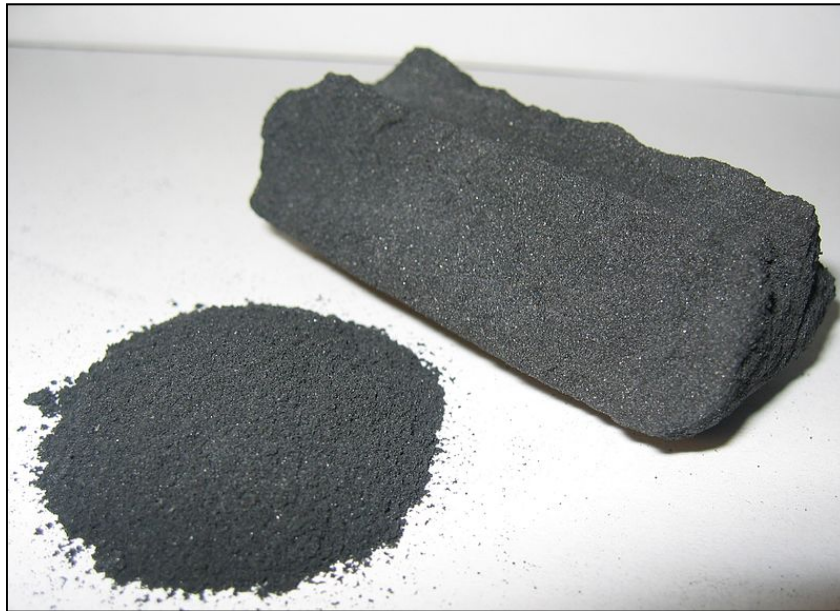
Figura 3.1. Carbón activado en polvo y en forma de bloque.
