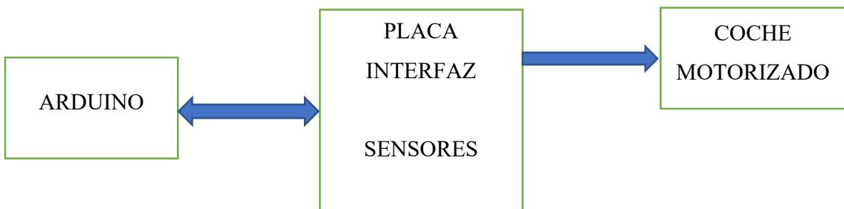
Dada la abundancia de material en internet acerca de este tipo de proyectos, frecuentemente haciendo uso de las entradas y salidas digitales de Arduino, para este proyecto se partió de la base de utilizar las entradas analógicas para decidir el giro y el sentido de marcha que debía efectuar el coche.
