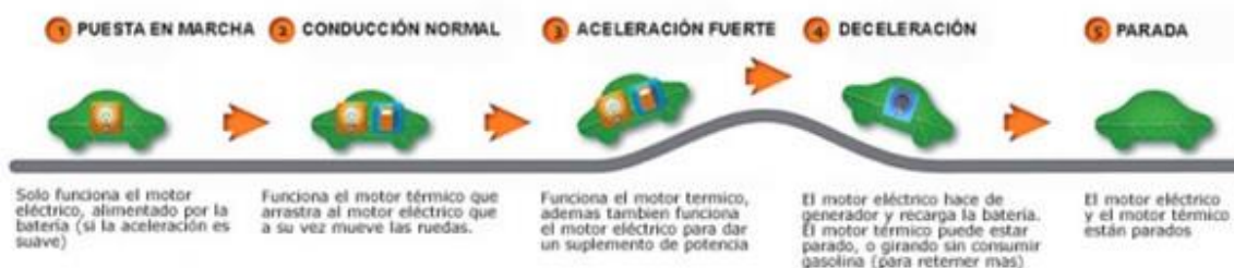
Figura 1. Esquema de los motores utilizados en cada fase de la conducción. (Fuente: MecanicaVirtual.com)
