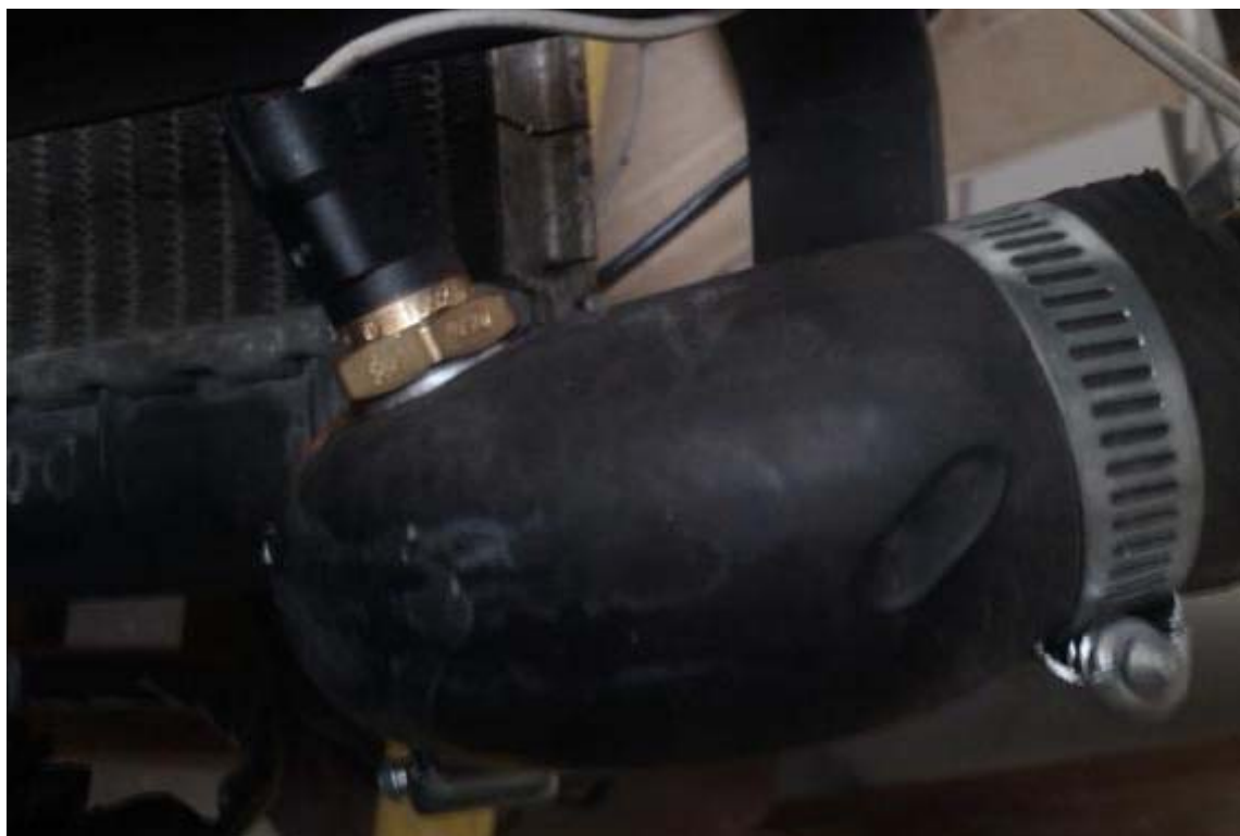
Figura 7.37: Montaje del sensor en el circuito de refrigeración
