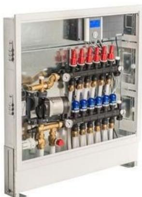
Kit colector 2 salidas: Cada kit incorpora 2 módulos básicos, 2 válvulas de paso, 2 termómetros, 2 purgadores automáticos, 1 llave de llenado, 2 tapones y soportes.
