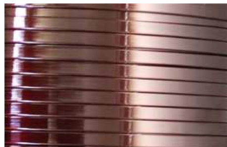
Fig. 9. Pletina de cobre aislada con esmalte.
