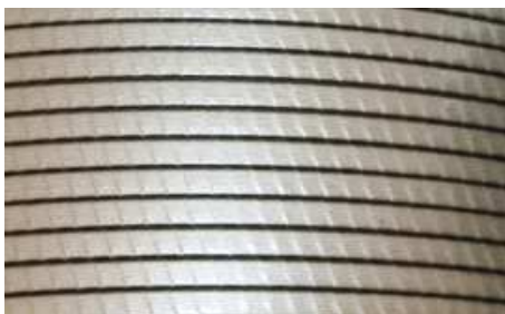
Fig. 8. Pletina de cobre aislada con papel kraft.
