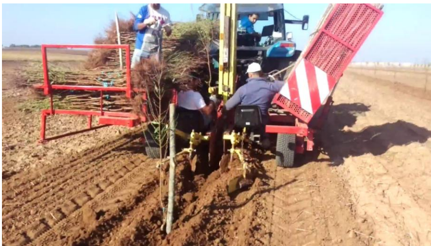
Ilustración 9. Máquina encargada de implantar la planta y el tutor en el suelo.
