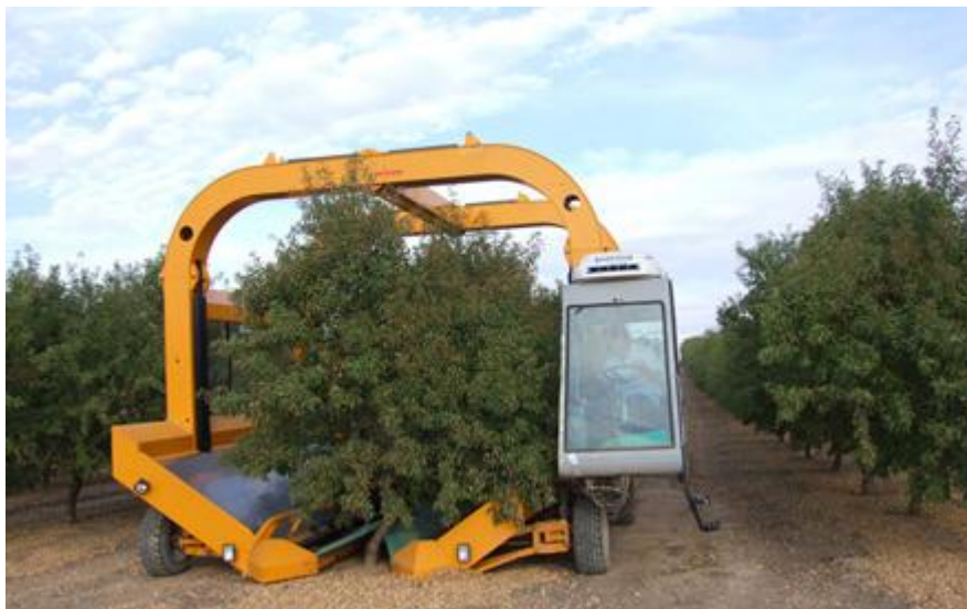
Ilustración 10. Máquina cabalgante de recolección de almendras.
