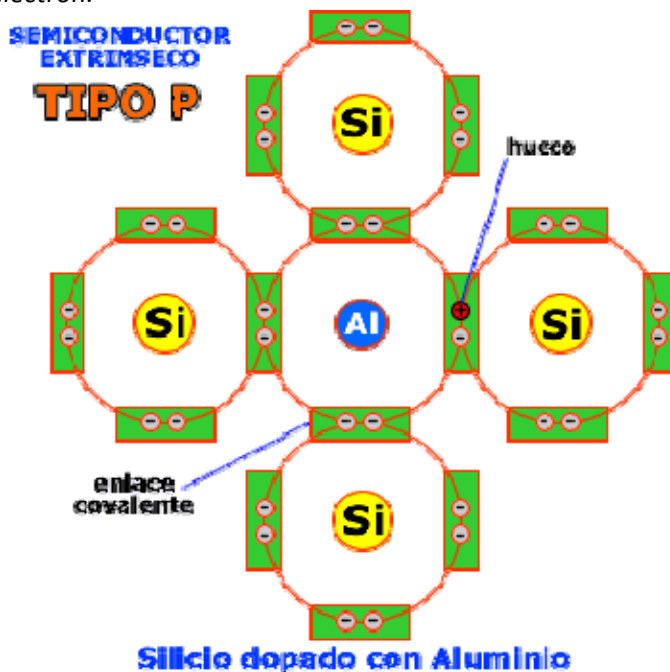
Figura 2.2. Esquema de un semiconductor tipo p.
