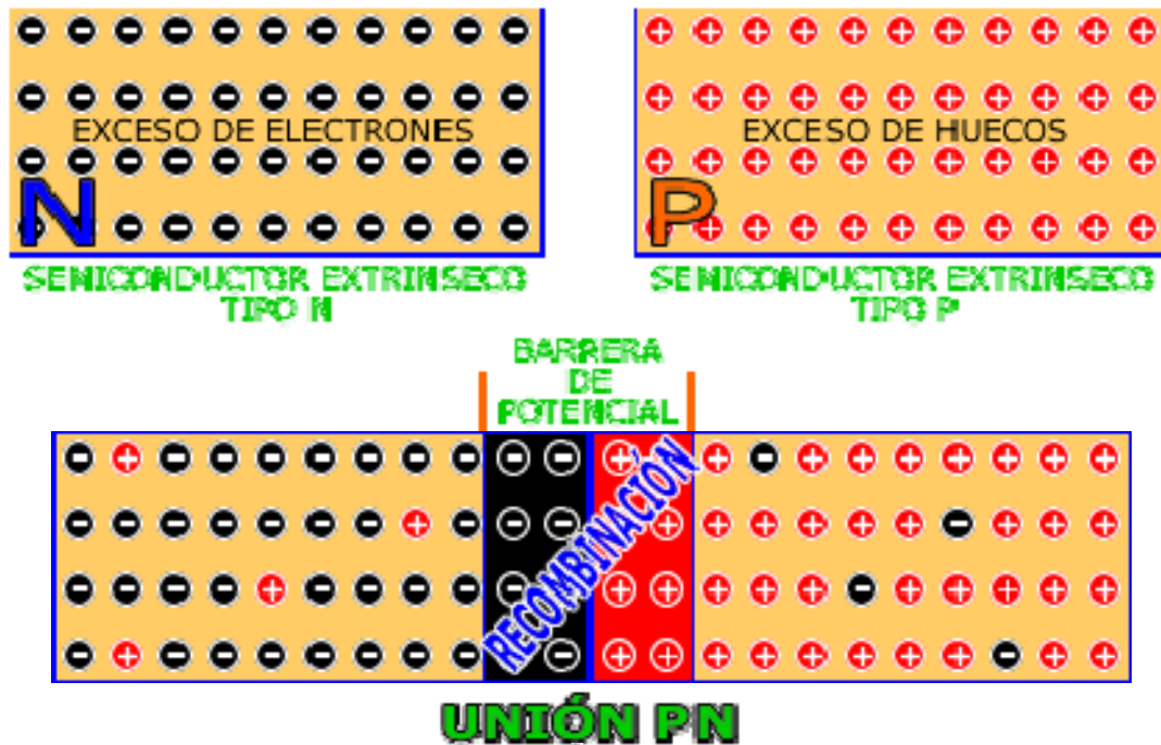
Figura 2.3. Esquema de la unión pn.
